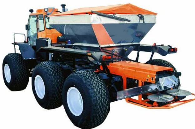
Рисунок 12 - Самоходный распределитель минеральных удобрений ТУМАН 3
