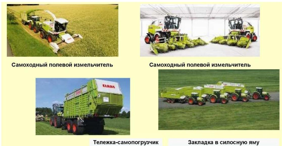
Рисунок 9 – Система машин для уборки кукурузы на силос
