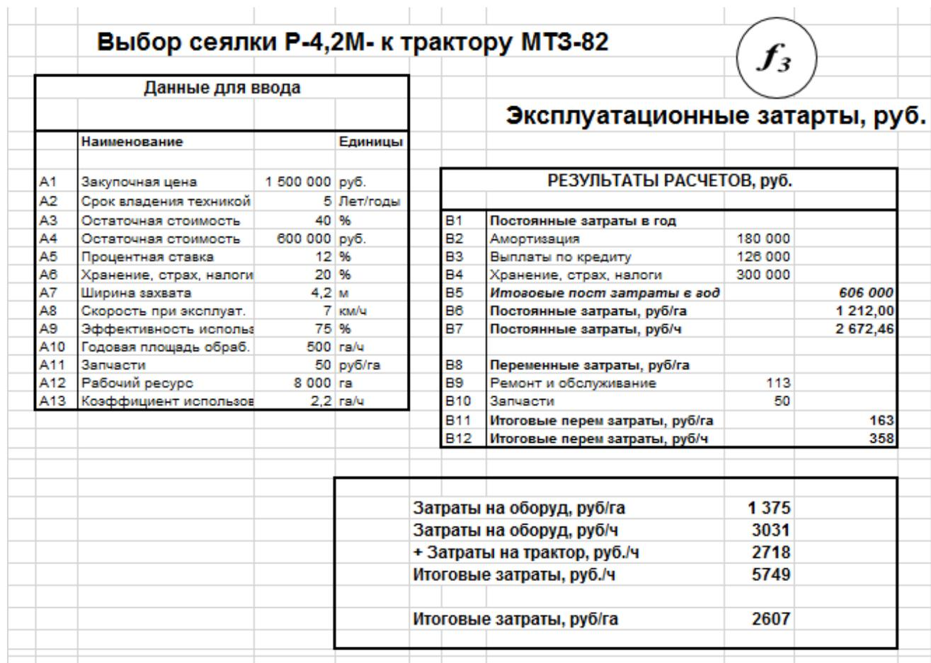
Рисунок 6 - Расчет  $f_3$  (сеялка Р-4,2М к трактору МТЗ-82)
