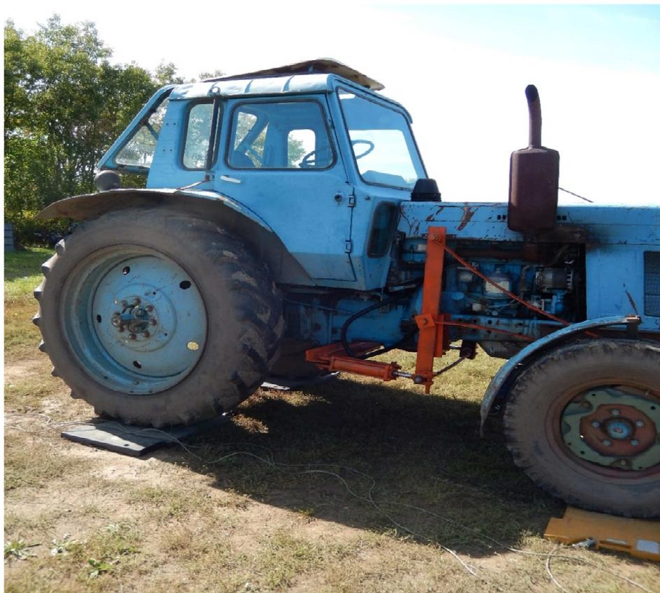
Рис. 3 – Фрагмент определения перераспределения нагрузки между двигателями энергетического средства
