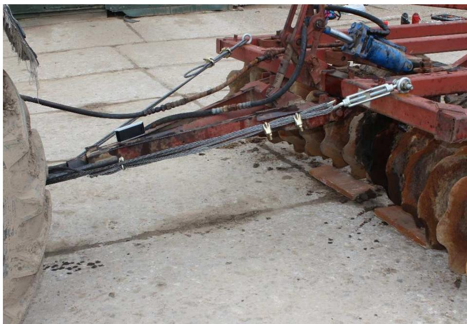
Рис. 4 – Общий вид МТА с устройством для перераспределения нагрузки между двигателями энергетического средства и бороной БДТ-3
