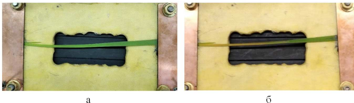
Рисунок 3 – Испытуемый образец (стебель растения), установленный в крепление-держатель во время испытания при воздействии постоянным напряжением величиной 500 В: а – до подключения к электрической цепи; б – результат воздействия электрическим током (пожелтение стебля со стороны отрицательного электрода)
