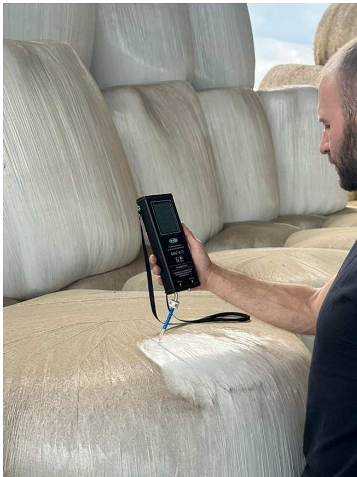
Рисунок 2 – Контроль содержания углекислого газа и кислорода в герметичном контейнере с сенажом газоанализатором МАГ-6П
