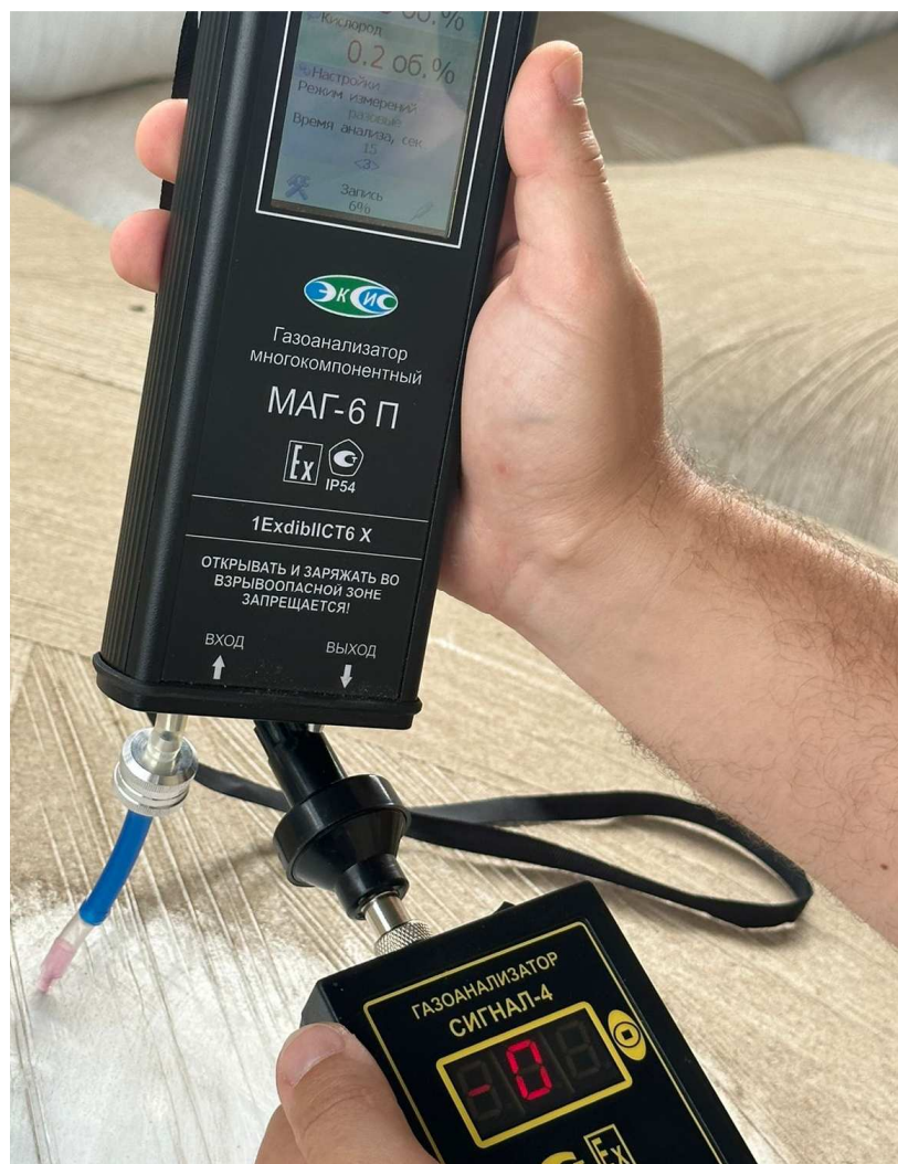
Рисунок 3 – Контроль содержания этилового спирта внутри рулона сенажа упакованного в агрострейч пленку
