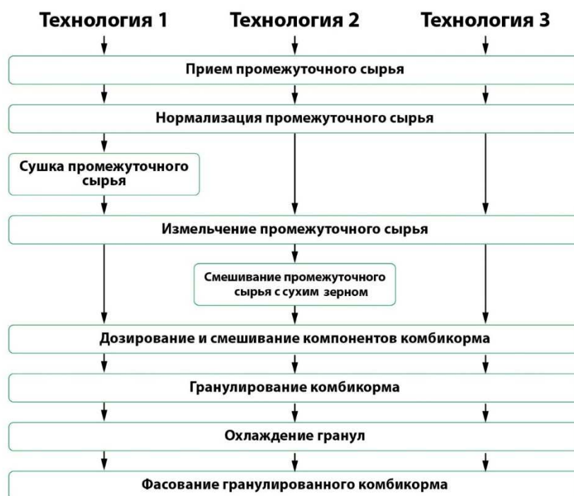
Рисунок 1 – Технологии производства комбикормов с добавлением зернового вороха пшеницы ранних фаз спелости
