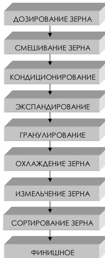
Рисунок 2 - Технологическая схема производства комбикормов
