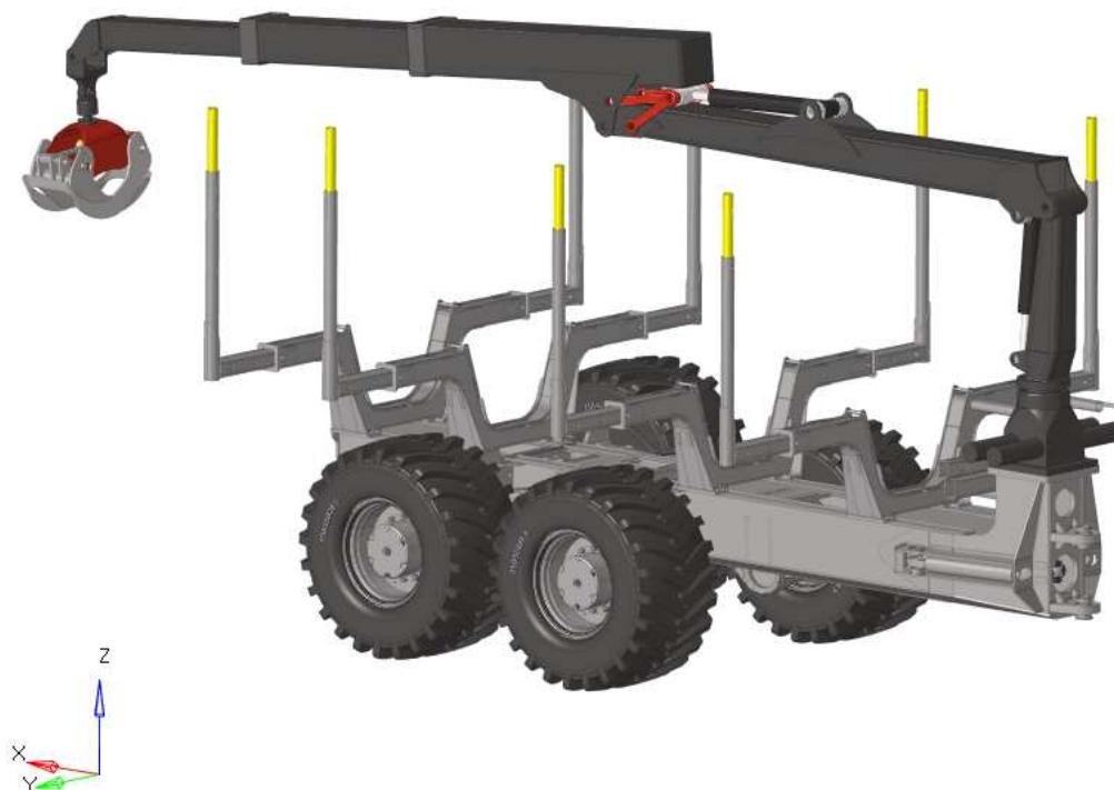
Рисунок 1 - 3d-модель рамы задней секции форвардера
