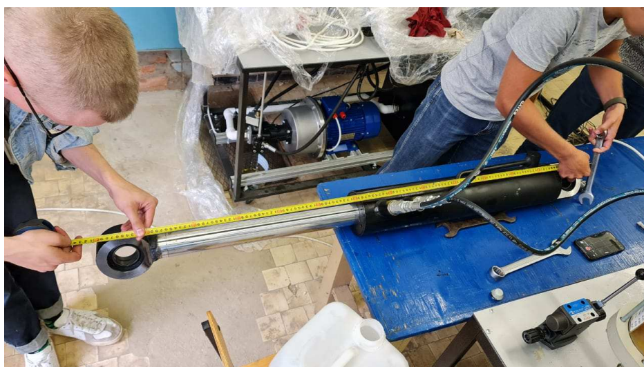
Рисунок 1 –ГЦ-110х60х484 рулевого управления с выдвинутым штоком во время испытаний
