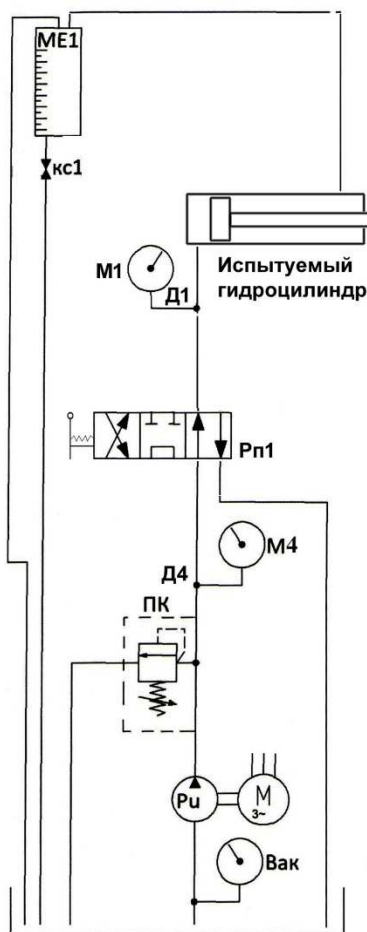
Рисунок 2 – Гидравлическая схема для исследования давления страгивания и давления холостого хода гидроцилиндра (ГЦ-110х60х484)
