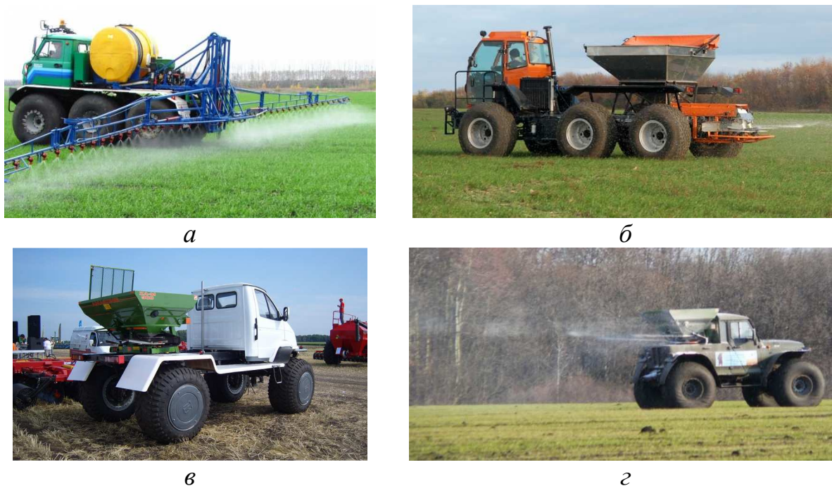
Рис. 1 Примеры существующих МКМ на шинах сверхнизкого давления для проведения агротехнических операций. а) МКМ-1901, б) Сельхозмашина «Туман-2» в) ТТС 30073 «Кержак», г) Трекол-Агро
