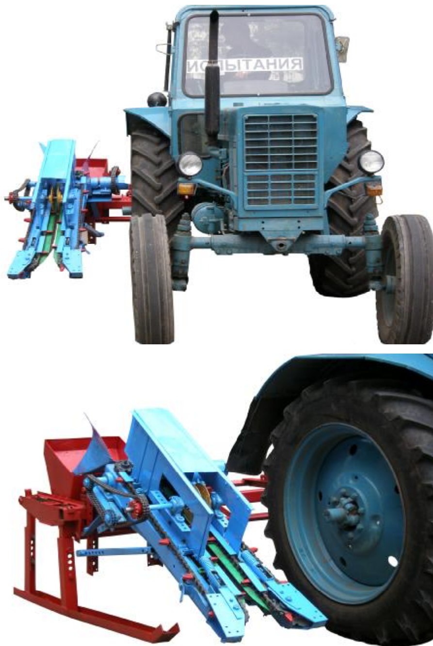
Рисунок 4 – Початкоотделяющий аппарат с вращающимися дисками
