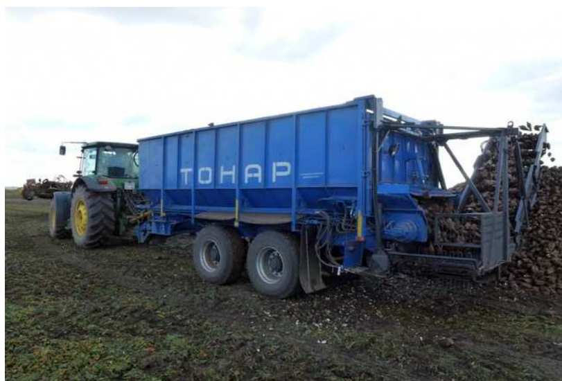
Рисунок 3 – Прицеп тракторный бункер-перегрузчик ТОНАР-ПТ4-0000030/40
