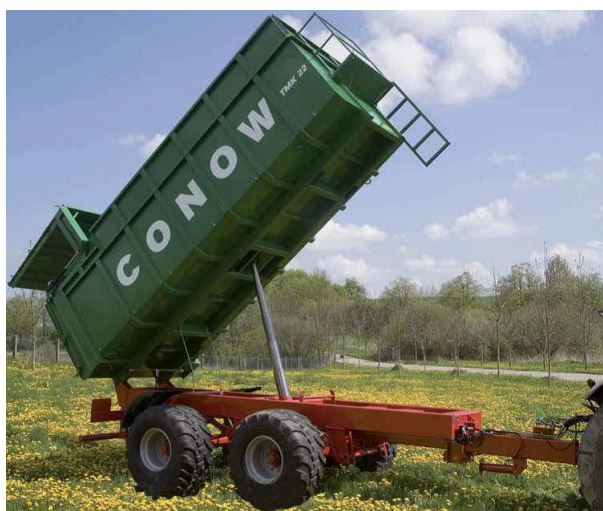
Рисунок 9 - Общий вид прицепа-самосвала с цельным кузовом ТМК 16/ТМК 22
