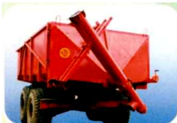
Рисунок 2 – Полуприцеп ПСТ-9 с перегружателем зерна ПНШ-1 (вид сзади)
