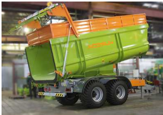
Рисунок 4 – Полуприцеп самосвальный ковшовый тракторный ПСКТ-18 «Хозяин»
