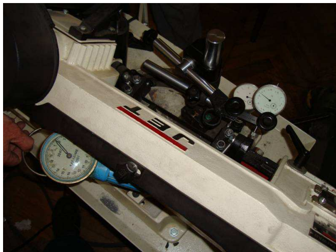
Рисунок 7-Опыт по определению угловой податливости пилы
