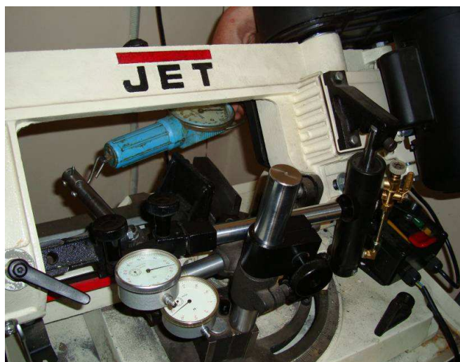
Рисунок 6 Опыт по определению крутильной податливости пилы
