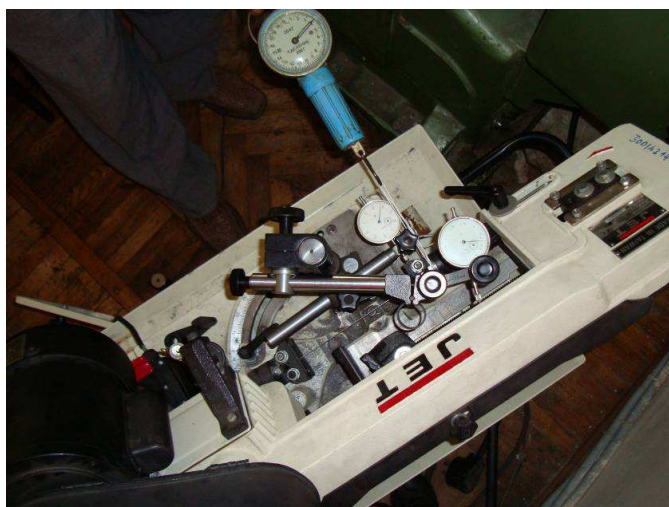
Рисунок 4-Опыт по определению осевой податливости
