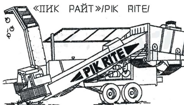
Рисунок 4 - Схема прицепного томатоуборочного комбайна Пик Райт (США)
