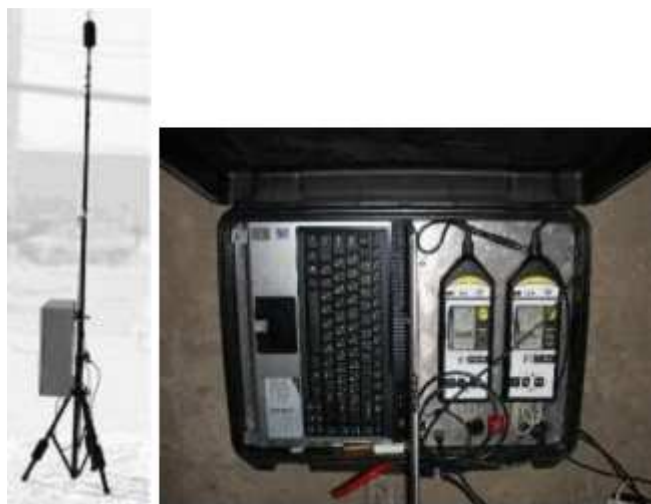
Рисунок 1 - Система автоматизированного мониторинга шума, оборудованная шумомерами, компьютером и адаптером беспроводной телеметрии по радиоканалу
