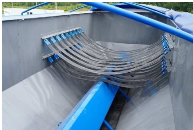
Рисунок 7 – Кузов полуприцепа «Тонар – 95235» с установленными ударогасящими ремнями и защитой донного транспортера
