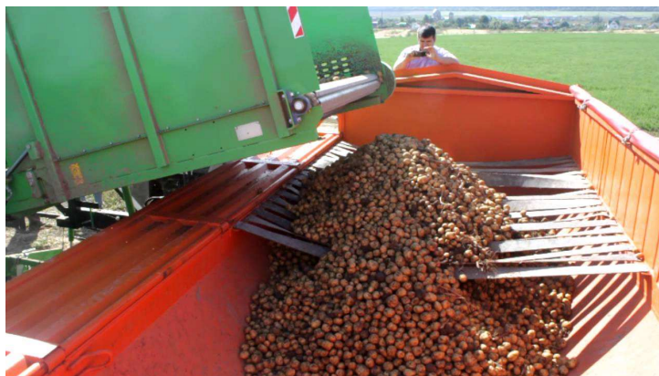
Рисунок 4 – Момент загрузки картофеля в кузов «Гранд – Полевик», оснащенный ремнями-гасителями
