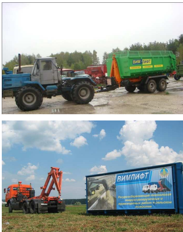
Рисунок 8 – Слева - полуприцеп с системой ВИМЛИФТ в сцепке с трактором Т-150К; справа – КамАЗ – 65115 с установленной системой ВИМЛИФТ.
