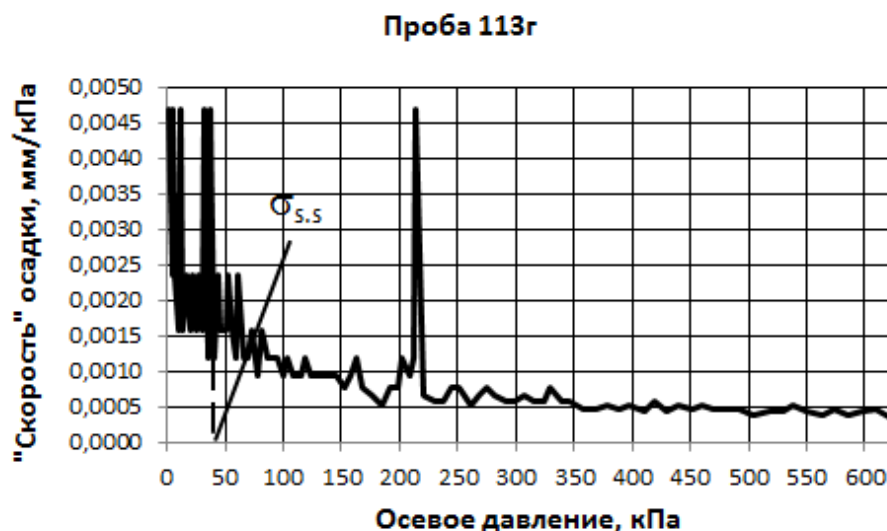
Рисунок 2 – «Скорость» осадки пробы песка при компрессионном сжатии
