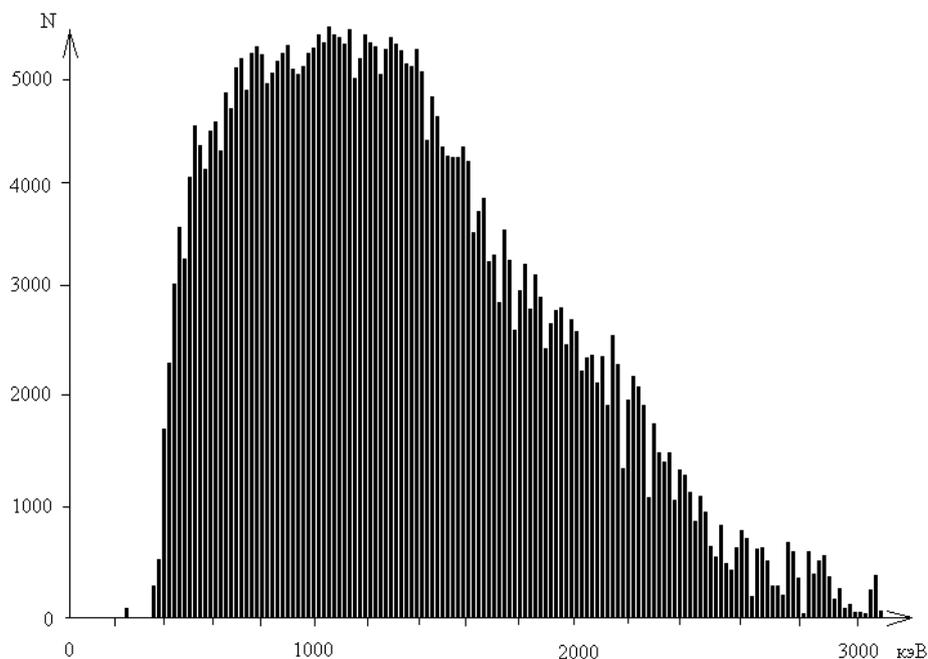
Рис. 5. Спектр фоновое  $\gamma$ -излучения в помещении лаборатории. Время измерения 1800сек, скорость счета гамма-квантов 26,82 имп/с.
