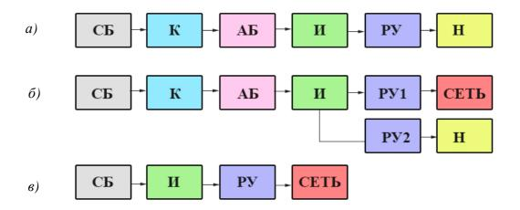
Рисунок 1 — Структурные схемы фотоэнергетических систем: солнечная батарея — СБ; контроллёр — К; аккумуляторная батарея — АБ; инвертор — И; распределительное устройство — РУ; нагрузка — Н
