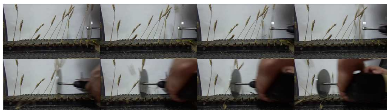
Рисунок 15 – Резание стеблей при угле наклона диска 70^{\circ}
