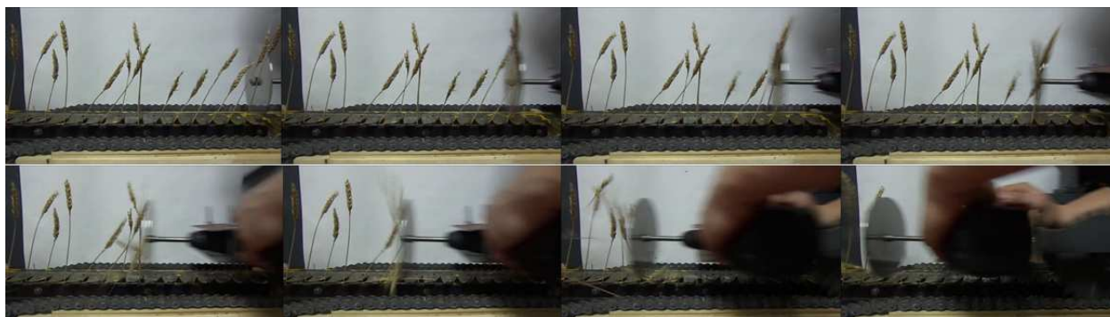
Рисунок 14 – Резание стеблей при угле наклона диска 80^{\circ}
