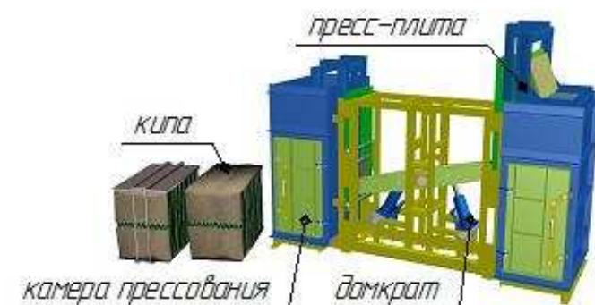
Рисунок 11 – Пресс для изготовления кип временной упаковки
