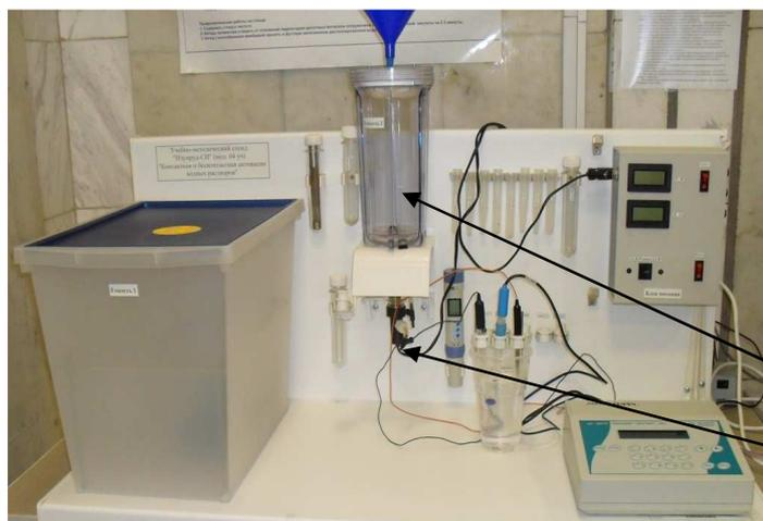
Рисунок 1 — Стенд для получения активированных водных растворов путем бесконтактной электроактивации «Изумруд СИ» (мод. 04 уч.)
