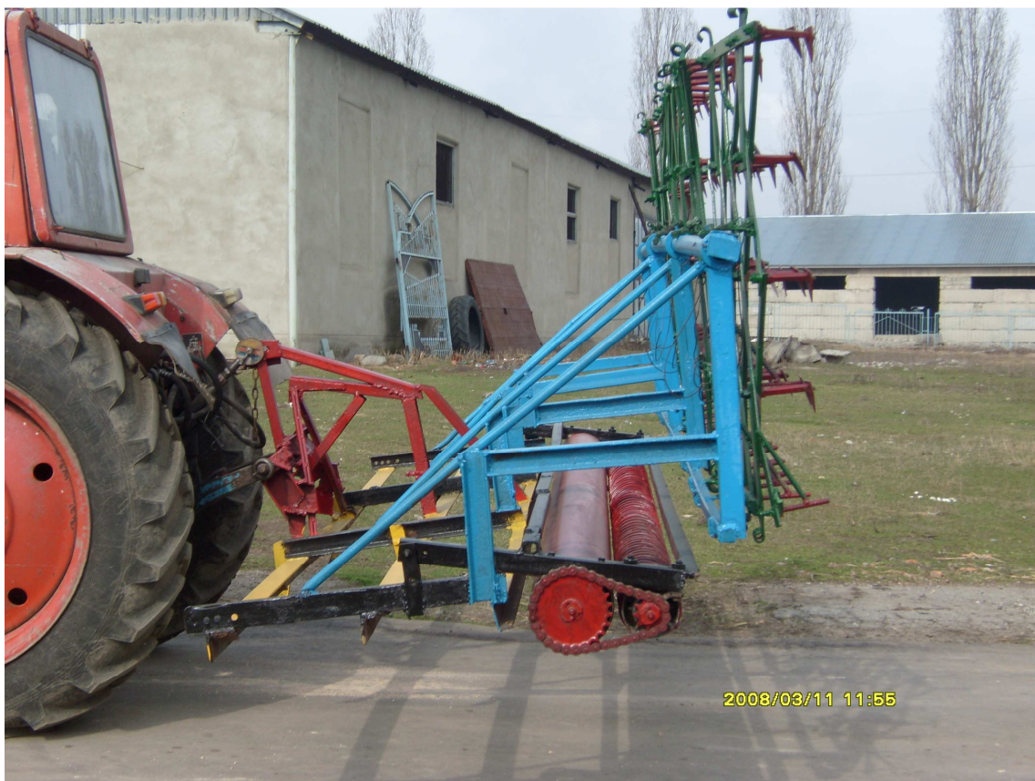
Рисунок 1 – Общий вид комбинированного почвообрабатывающего агрегата с трактором (транспортное положение)
