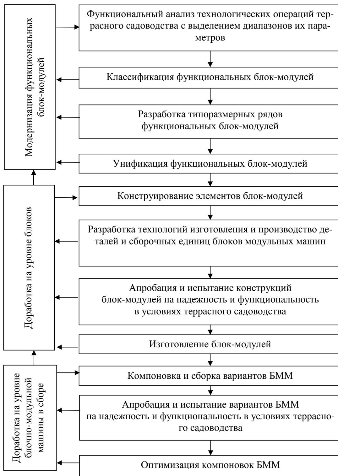
Рисунок 1 – Схема проектирования блочно-модульных машин для террасного садоводства
