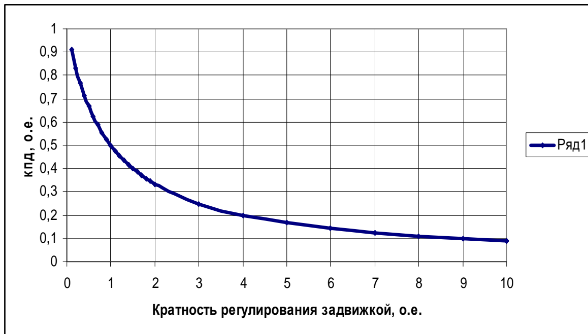
Рисунок 3. Зависимость КПД от кратности регулирования задвижкой
