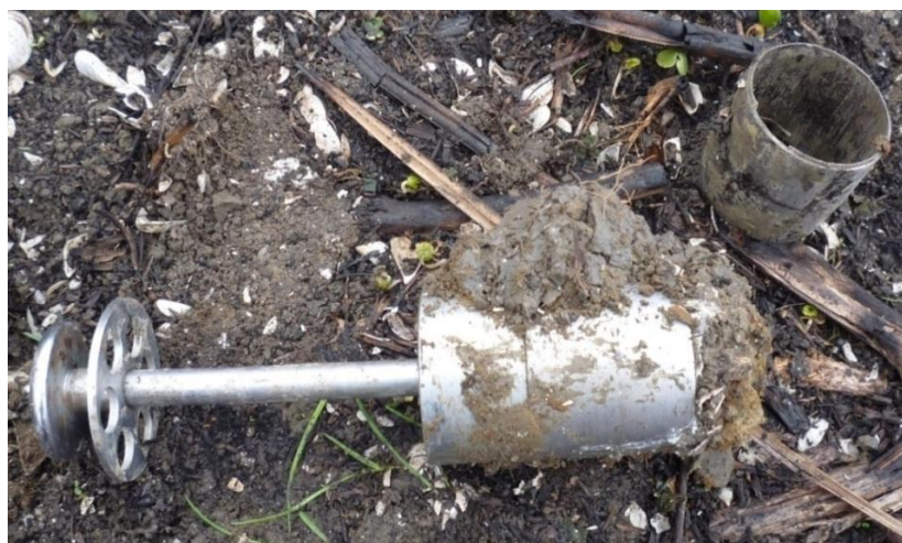
Рисунок 1 – отбор грунта, ПК 140 Шапсугского водохранилища
