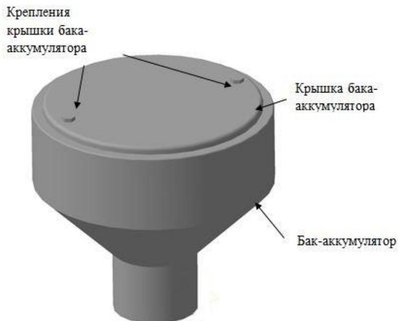
Рисунок 2 - Внешний вид бака-аккумулятора
