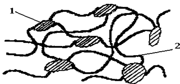
Рисунок 3 - Структура СВМПЭ (1 - кристаллические образования; 2 – проходные макромолекулы)
