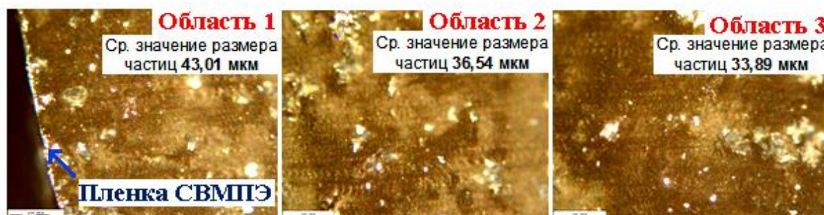
Рисунок 4 - Распределение частиц СВМПЭ (Мм 3,9 млн). в эластомерной матрице.
