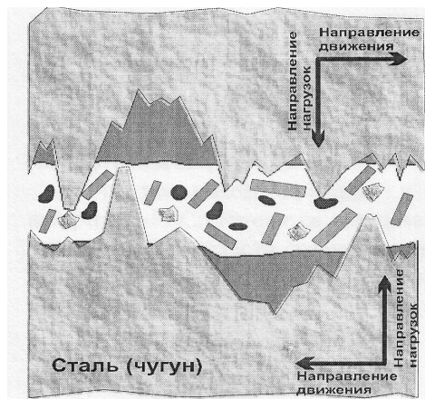
Рисунок 7. Выступы микрорельефа поверхностей трения
