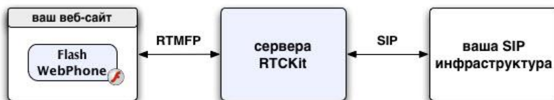
Рисунок 2. Схема передачи потоковых данных с помощью сервиса rtckit.com .
