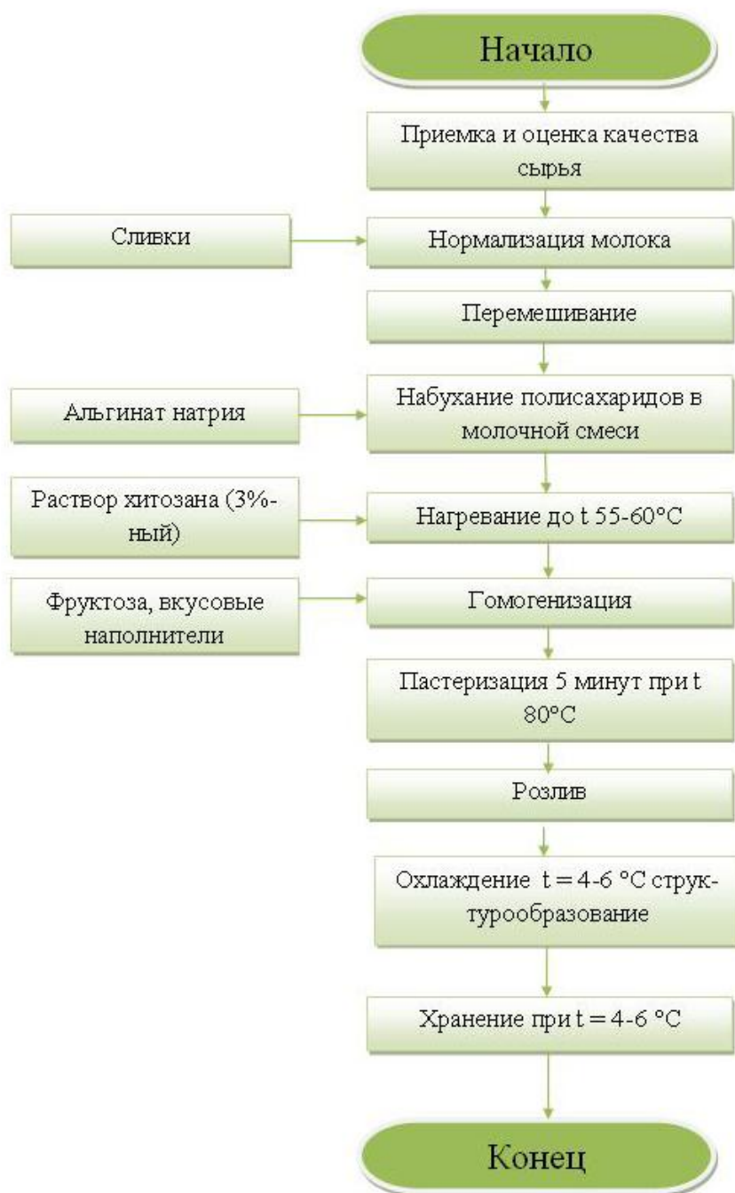
Рисунок 2 – Технологическая схема производства функционального молочного пудинга с композицией полисахаридов
