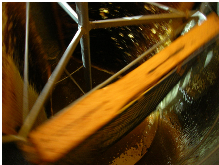
Рисунок 2 – Изображение вращающегося барабана центрифуги М-3 с соторамками с фиксацией факта начала откачки меда.
