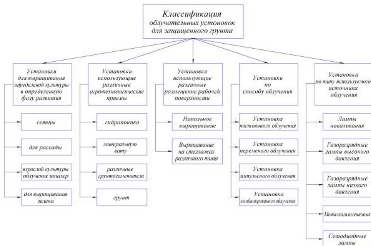
Рисунок 1 - Классификация установок для выращивания овощей в сооружениях защищенного грунта.
