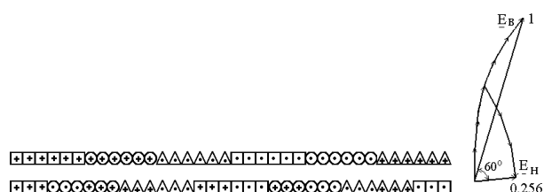
Рис. 21 - Схема токов в слое катушек до и после модуляции и векторная диаграмма ЭДС, b = 2\pi/3 (последовательность соединения фаз А, В, С)
