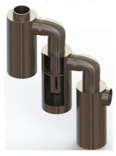
Рисунок 1 – Последовательно соединенные центробежные воздушные классификаторы
