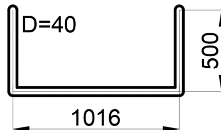
Рис. 9. Эскиз стабилизатора поперечной устойчивости задней оси
