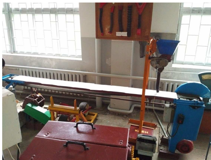
Рисунок 11 – Общий вид лабораторной установки для проведения исследований для оценки качественных показателей работы катушечно-секционного высевающего аппарата
