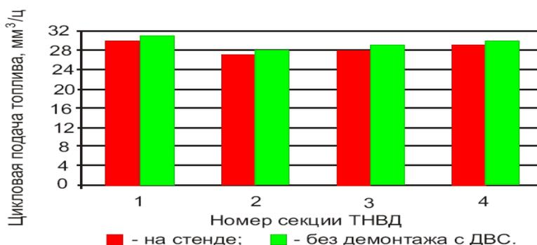
**Рисунок 8 – Результаты контроля регулировки ТНВД на режиме холостого хода при  $n = 1800 \text{ мин}^{-1}$**
