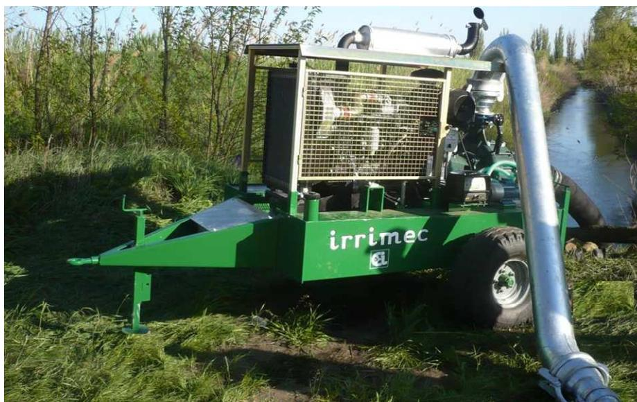
Рисунок 3 – Мобильная насосная станция «Irrimes»
