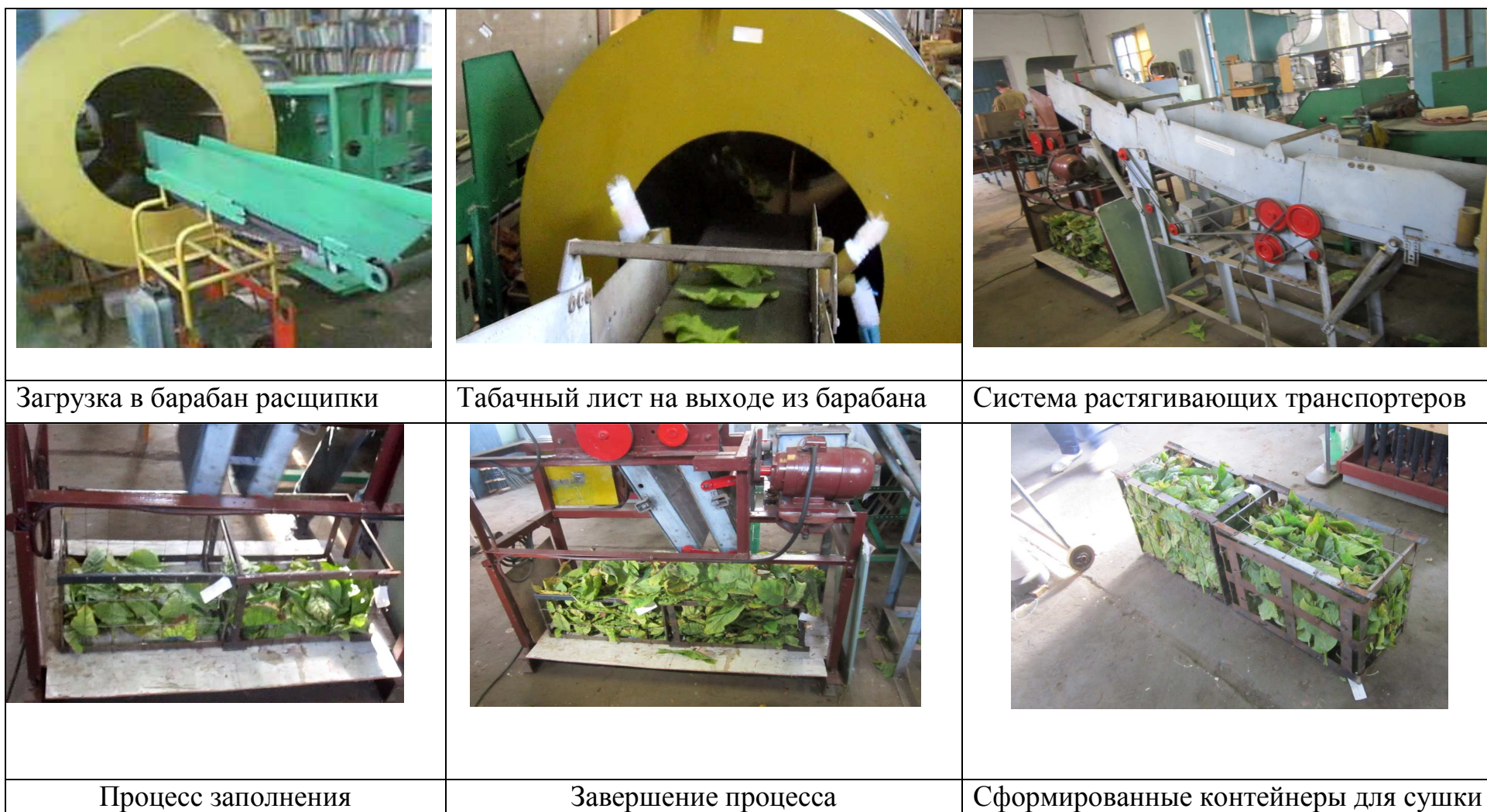
Рисунок 5 – Технологический процесс подготовки табака к сушке
