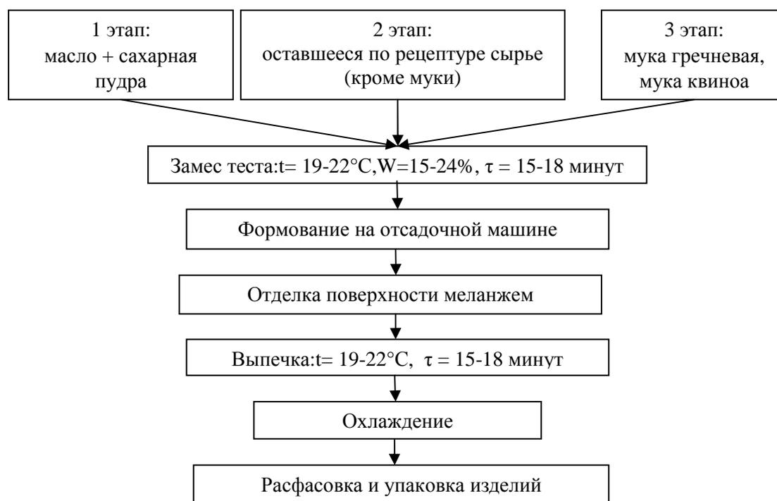
Рисунок 1 – Структурная схема производства песочного печенья
