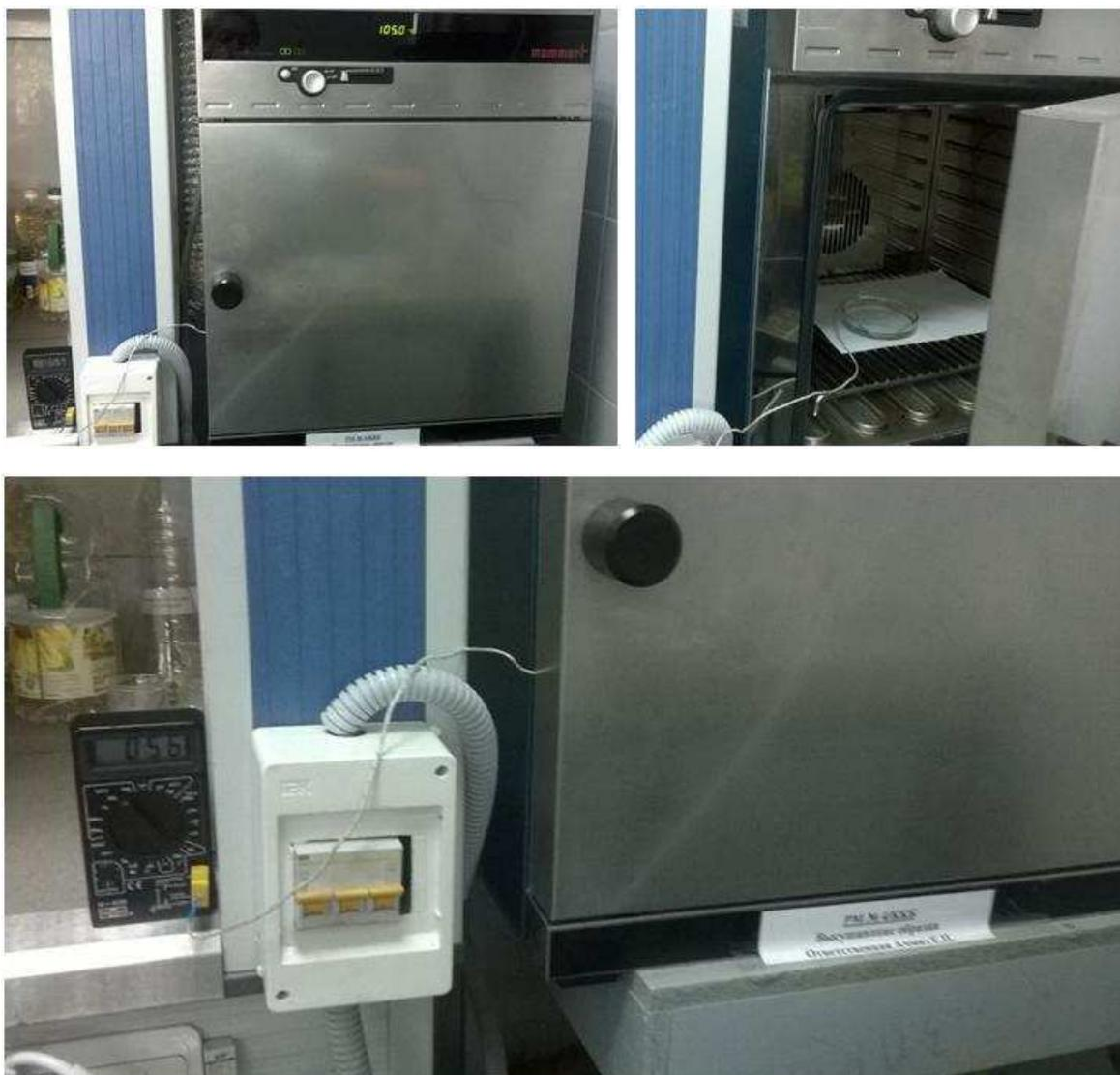
Рисунок 4 – Измерение температуры навески воды в среднем слое
