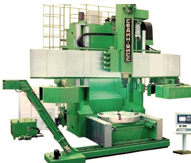
Рисунок 1 – Многоцелевой станочный комплекс VM 32.
