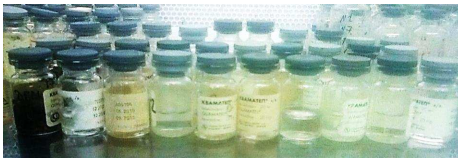
Рисунок 4 - Ряд разведений методом Коха.
