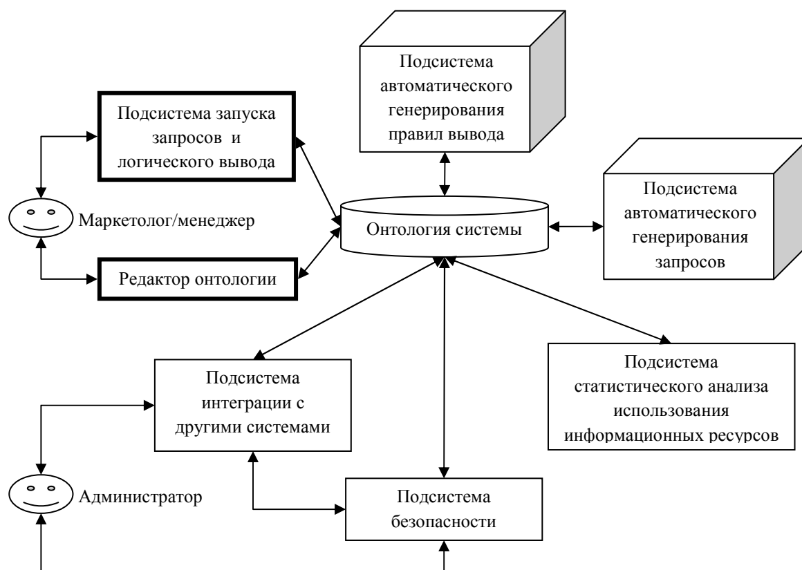
Рис. 3. Обобщенная структурная схема автоматизированной системы
