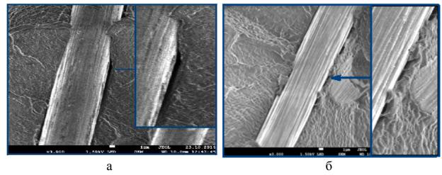
Рисунок 2 – Микрофотографии композитов: а – ПЭ2НТ11+УКН-М; б – ПЭ2НТ11+ модифицированные волокна марки ВМН-4ПКТ
