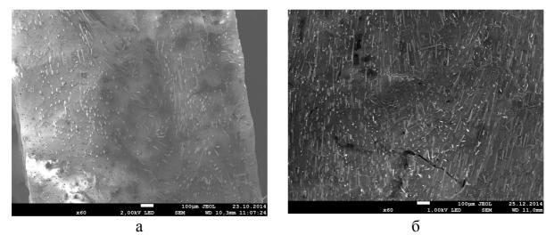
Рисунок 3 — Микрофотографии углекомпозитов состава ПЭ2НТ11+10 мас.% УКН-М вдоль направления экструдирования (x60): а — лабораторный образец; б - труба
