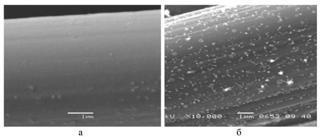
Рисунок 1 – Микрофотографии поверхности углеродных волокон: а – волокна марки ВМН-4ПКТ; б – поверхностно-модифицированные волокна марки ВМН-4ПКТ
