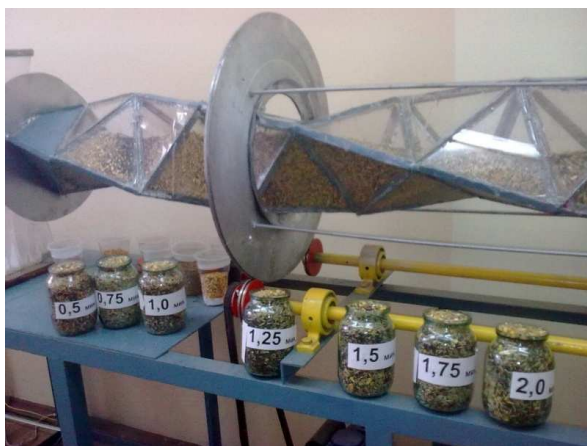
Рисунок 9 – Модельная экспериментальная установка на базе релятивного винтового барабана РЦ 5.1.а (вид спереди)
