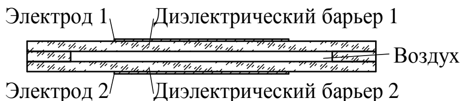
Рисунок 3 – Сечение канала разрядного устройства электроозонатора
