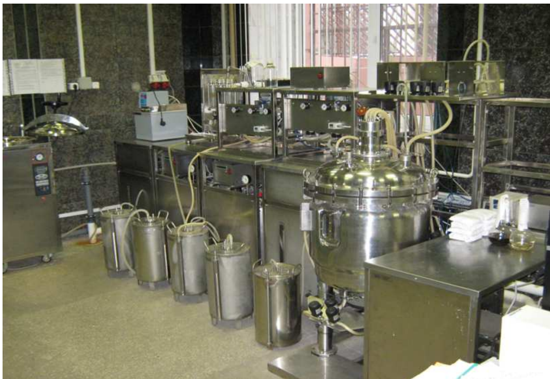
Рисунок 2 – Внешний вид установки для производства биологически активных добавок оснащенной термостерилизующим устройством
