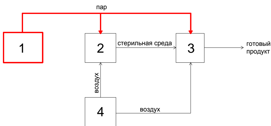
Рисунок 3 – Структурная схема установки для производства биологически активных добавок оснащенной термостерилизационным устройством где 1 – парогенератор; 2– стерилизатор растворов; 3– ферментер; 4- стерилизатор газов.
