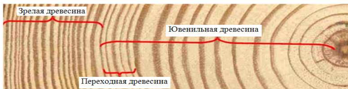
Рисунок 1 - Срез сосны, показывающий зоны древесины
